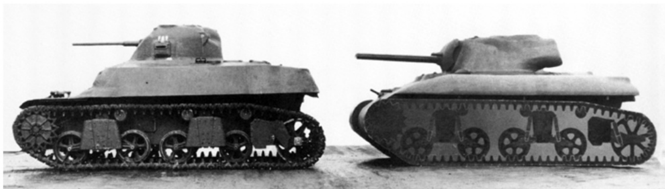
Foto's die gemaakt zijn om de T7 te vergelijken met de mock-up van de T7E2. Let op het grote verschil in afmeting.
