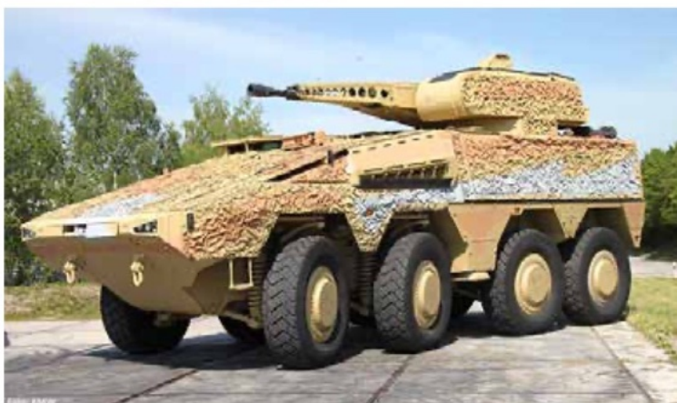
Een zogenoemde "PuBo" Boxer met een RCT 30 Puma toren
